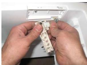
Retire la tarjeta LED y saque el cable de datos.
