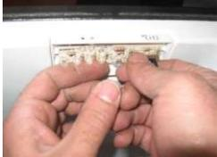
Setzen Sie die neue Steckplatine auf.
