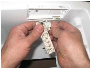
Ziehen Sie den LED-Steckplatine und Datakabel ab.
